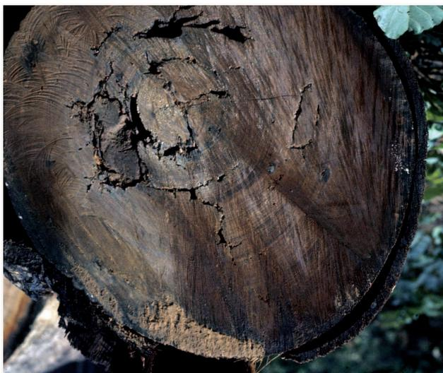
Section de grume montrant des traces d'attaque de termites et de pourriture fibreuse (Guyane).
