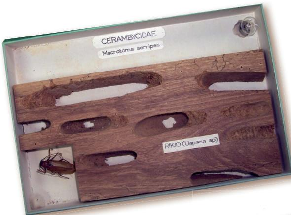
Détériorations de type « mulotage » provoquées par des cérambycides sur Rikio (Cameroun).
