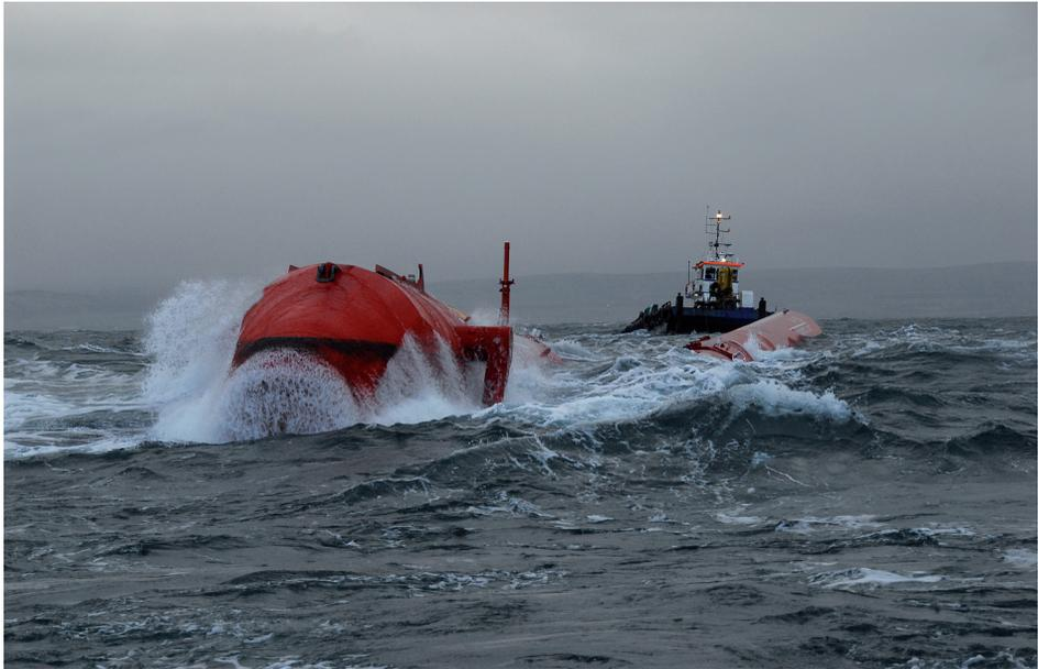
■ Photo 1 : le Pelamis, système de récupération de l'énergie des vagues, en test par mauvais temps à l'EMEC (European Marine Energy Center) en Écosse (© Pelamis Wave Power Ltd, UK).
